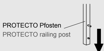
Schieben Sie den PROTECTO Pfosten für den Seitenschutz bis zum Einrasten in den PROTECTO HT-Anschluss ein.
