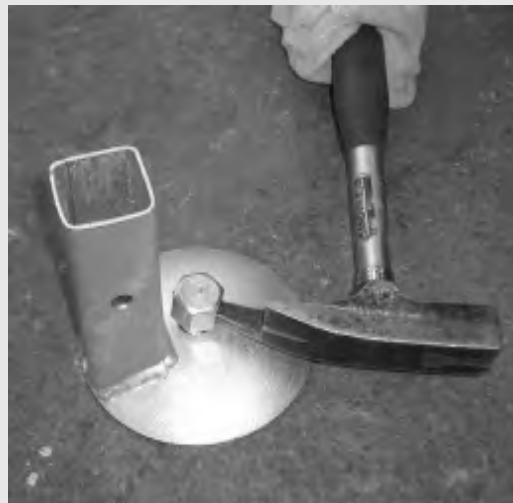
Die eingebaute Schraube des PROTECTO Schraubfußes kann mit der Spitze eines Hammers oder mit einem Ring- oder Maulschlüssel SW 24 angezogen werden.
